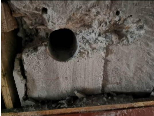
附照 25 取芯检测混凝土强度
